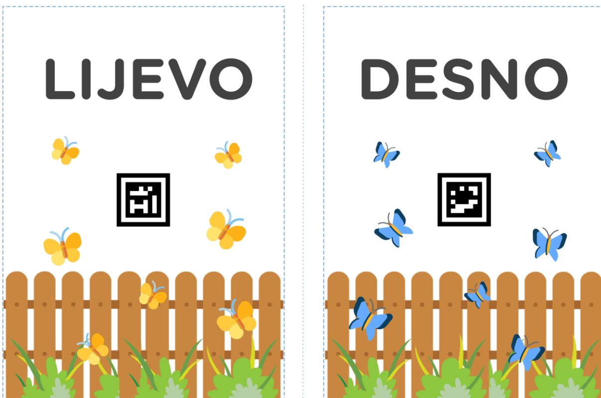
Zato prije programiranja naučite HuskyLens kameru da prepozna i jednu i drugu oznaku te programirajte robot da bude spreman proći i jednom i drugom rutom. Prije programiranja podesite kut gledanja kamere kako bi očitavanje tag označe bilo uspješno.
